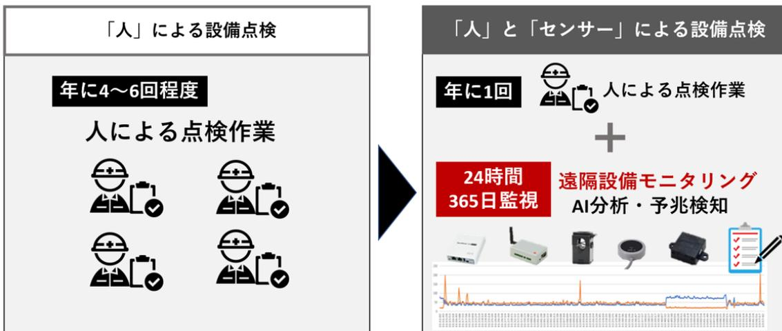
給排水ポンプや分電盤等のライフライン設備に専用のセンサーを設置することで、24時間365日の稼働監視・故障検知を行うことができます。
